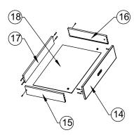
Левый и правый фиксаторы от направляющих прикрепить при помощи саморезов 3,5х15 ко дну ящика
