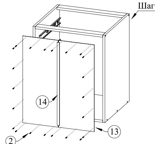
Соедините задние стенки (13) с помощью соединительной планки (14), затем притяните их к корпусу шкафа (шаг 3) саморезами 4x16 (2)
