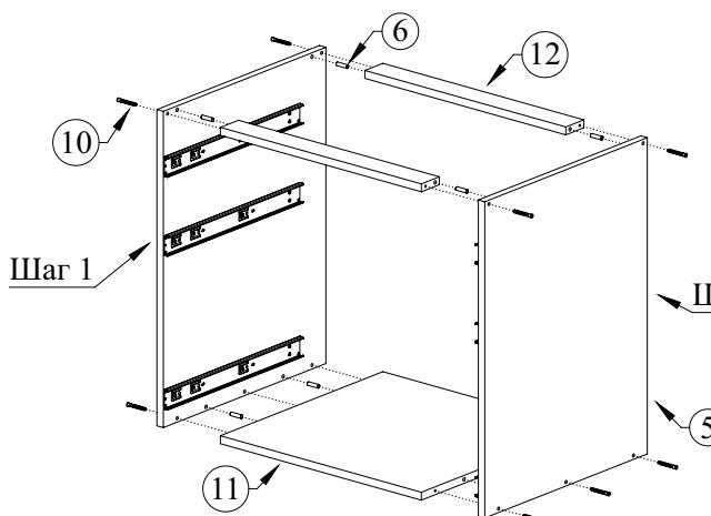
При помощи шкантов (6) и конформаторов (10) скрепите боковые стенки (5), основание (11) и поперечины (12)
