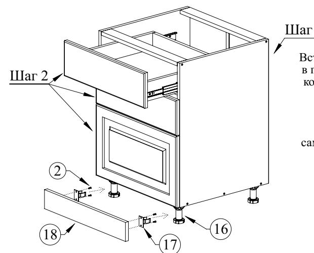
Вставьте ящики внутренними направляющими в подвижные части внешних направляющих в корпусе тумбы. Задвиньте ящик до фиксации деблокировочным рычагом.
