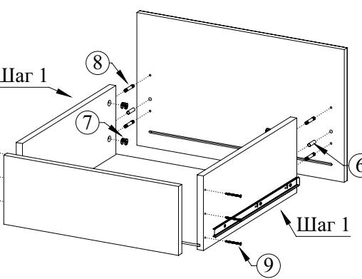
При помощи шкантов (6), эксцентриковой стяжки [эксцентрик (7), шток эксцентрика (8)] и саморезов 4x30 (9) скрепите в единую конструкцию стенки, днища и фасады ящиков
