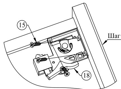
Установить и закрепить фиксаторы (18) саморезами 3,5x15 как показано на рисунке.
