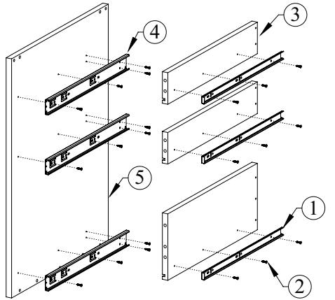
У направляющих нажмите на деблокировочный рычаг, который находится внутри подвижной планки. Снимите внутренние подвижные планки (1) и прикрутите их саморезами 4x16 (2) к боковым стенкам ящиков (3), а внешние неподвижные планки (4) к боковым стенкам тумбы (5)
