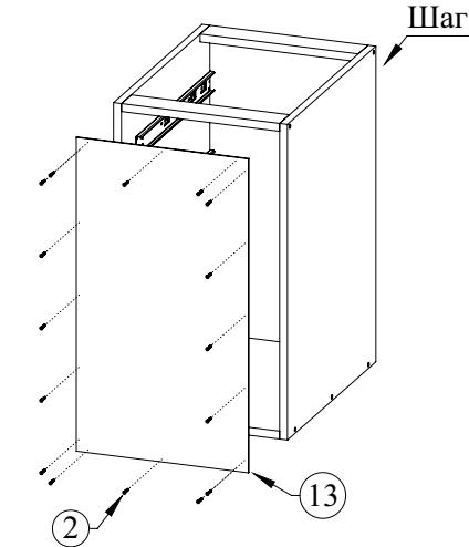
Притяните заднюю стенку (13) к корпусу шкафа (шаг 3) саморезами 4x16 (2)
