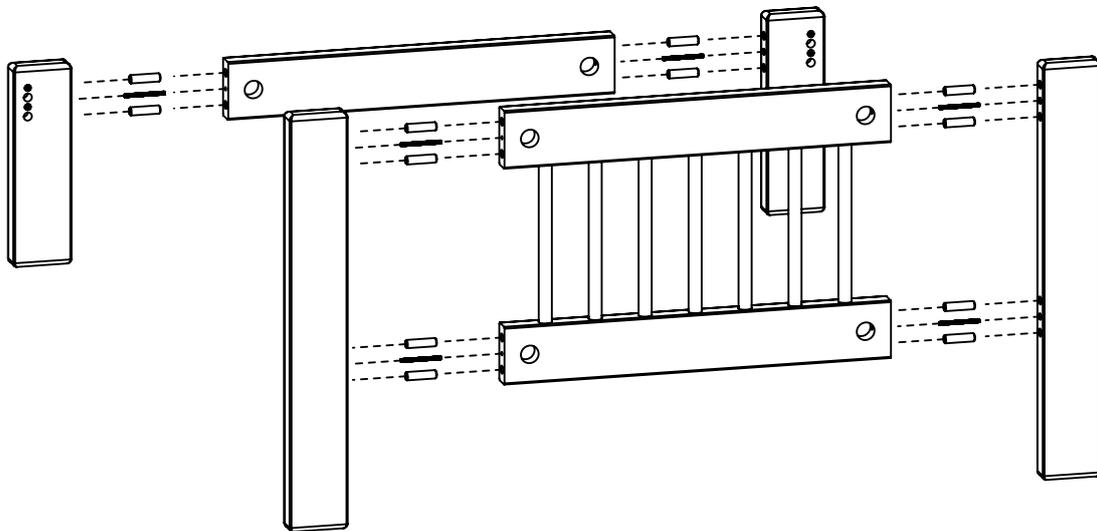
Установить вкладыши в крепёжные отверстия на шпильки. Стянуть столбы с поперечинами, накрутив гайки на шпильки до упора во вкладыши, при помощи гаечного ключа. Крепёжные отверстия изголовья закрыть заглушками.
