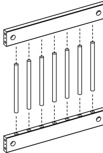
Вкрутить в столбы резьбовые шпильки и вставить шканты. Соединить столбы с поперечинами.
