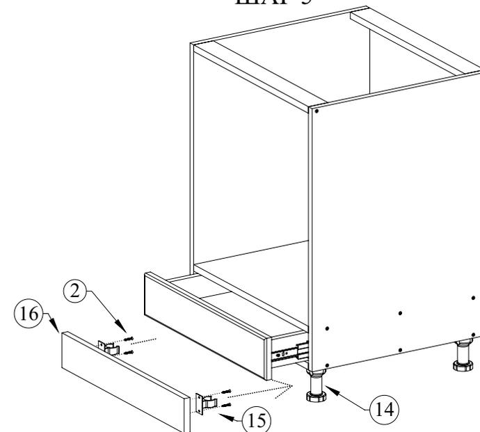
Вставьте ящик внутренними направляющими в подвижные части внешних направляющих в корпусе тумбы. Задвиньте ящик до фиксации деблокировочным рычагом. Для снятия ящика также используйте деблокировочный рычаг. Прикрепите клипсы (15) к коклю (16) саморезами 4x16 (2), затем при помощи клипс прикрепите цоколь к ножкам 14
