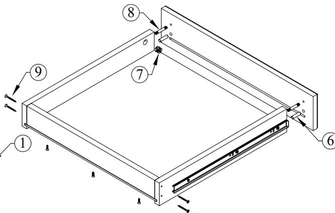
При помощи шкантов (6), эксцентриковой стяжки [эксцентрик (7), шток эксцентрика (8)] и саморезов 4x30 (9) скрепите в единую конструкцию дно, фасад и стенки ящика (3) с ранее прикрученными направляющими.
