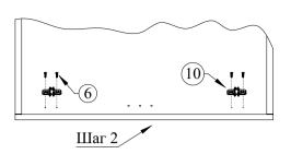
Разъедините чашу и ответную планку петель, скрепленные между собой. Прикрутите ответные планки (10) петель при помощи саморезов 4х16 (6) в размеченные под них отверстия в боковых стенках тумбы
