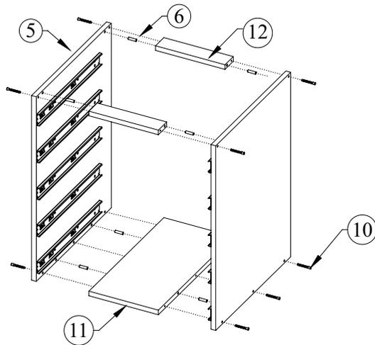
При помощи шкантов (6) и конфирматов (10) скрепите боковые стенки (5), основание (11) и поперечины (12)
