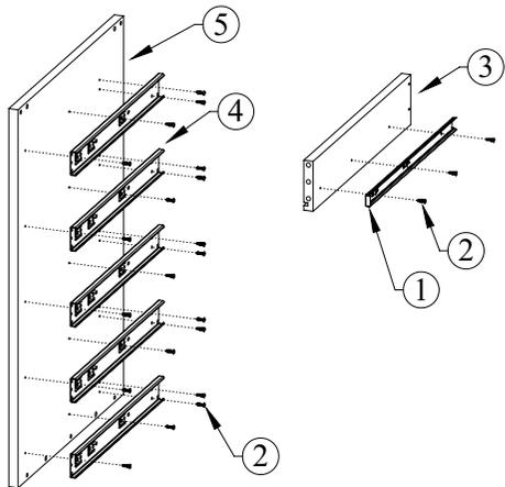
У направляющих нажмите на деблокировочный рычаг, который находится внутри подвижной планки. Снимите внутренние подвижные планки (1) и прикрутите их саморезам 4x16 (2) к боковым стенкам ящиков(3), а внешние неподвижные планки (4) к боковым стенкам тумбы (5)
