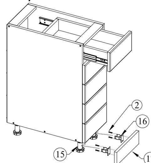
Вставьте ящик внутренними направляющими в корпус тумбы. Задвиньте ящик до фиксации деблокировочным рычагом. Для снятия ящика также используйте деблокировочный рычаг.
