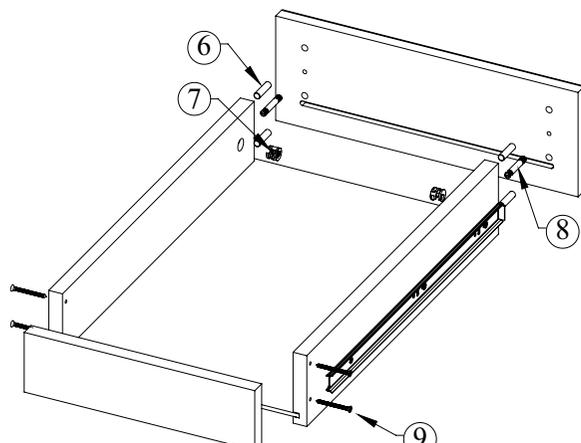
При помощи шкантов (6), эксцентриковой стяжки [эксцентрик (7), шток эксцентрика (8)] и саморезов 4x30 (9) скрепите в единую конструкцию дно, фасад и стенки ящика (3) с ранее прикрученными направляющими.
