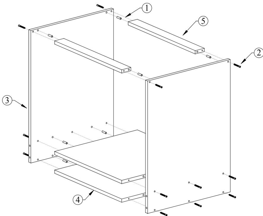
При помощи шкантов (1) и конфирматов (2) скрепить в единую конструкцию боковые стенки (3), основания (4) и поперечины (5)
