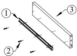
У направляющих нажмите на деблокировочный рычаг, который находится внутри подвижной планки. Снимите внутренние подвижные планки (1) и прикрутите их саморезам 4x16 (2) к боковым стенкам ящика (3).
