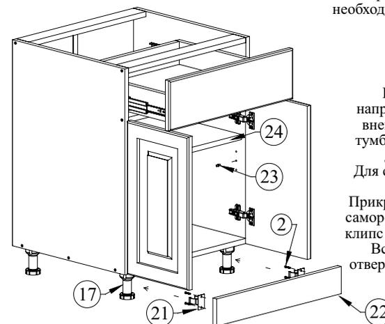
Вставьте ящик внутренними направляющими в подвижные части внешних направляющих в корпусе тумбы. Задвиньте ящик до фиксации деблокировочным рычагом. Для снятия ящика также используйте деблокировочный рычаг. Прикрепите клипсы (21) к колоду (22) саморезами 4x16 (2), затем при помощи клипс прикрепите цоколь к ножкам (17). Вставьте полкодержатели (23) в отверстия боковых стенок, установите полку (24)
