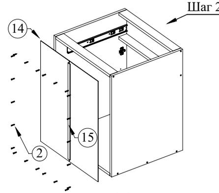
Соедините задние стенки (14) с помощью соединительной планки (15), затем притяните их к корпусу шкафа (шаг 2) саморезами 4x16 (2)
