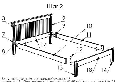
Вкрутить штоки эксцентриков большие (8) во втулки (7). При помощи шкантов 16х60 (9) соединить царги (10, 11) со столбами (2, 3, 13, 14). Эксцентриками D35 (12) притянуть штоки эксцентриков большие (8).
