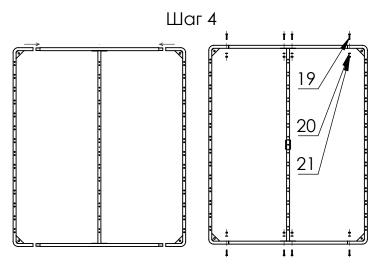
Скрутить металлическое основание используя болт М8х50 (19), шайбу М8(20), гайку М8(21).
