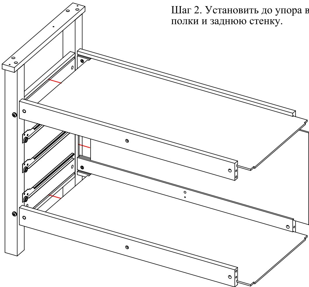
Шаг 3. Притянуть поперечины к столбам с помощью винтов и гаек-бочонков. Выступающие части полок и задней стенки должны попасть в пазы столбов и боковин.
