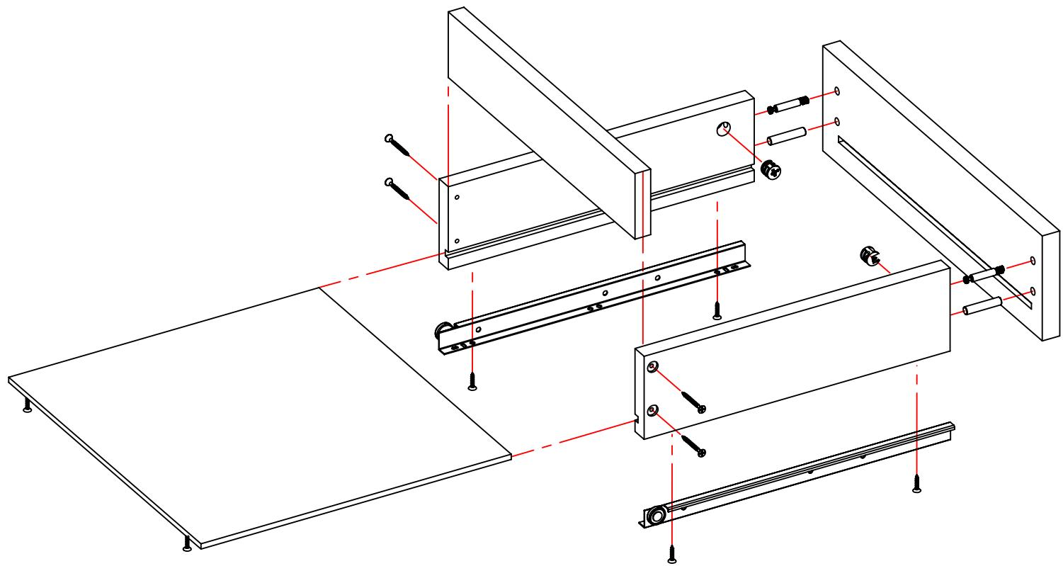
Шаг 6. Прикрепить малыми саморезами к центральной стенке направляющие для ящиков. Установить центральную стенку вертикально внутрь, соблюдая расстояние для свободного хода ящиков по направляющим. Убедившись в плавном ходе каждого ящика, зафиксируйте центральную стенку саморезами спереди и сзади.
