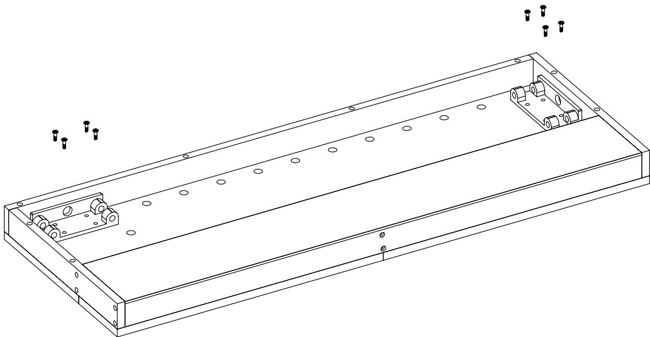
Шаг 8 . Зафиксировать столешницу к основанию верстака при помощи саморезов.
