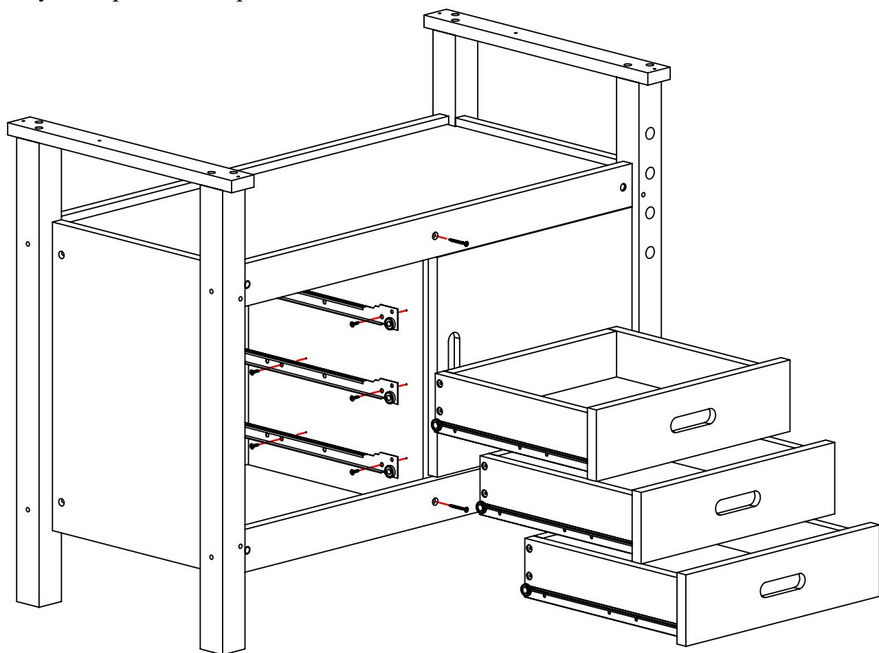
Шаг 7. При помощи малых винтов к внутренней части столешницы прикрепить две металлические направляющие. Убедитесь в плавности хода винта.
