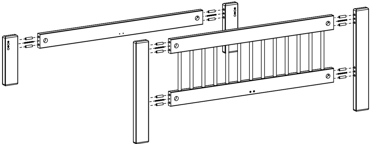
Установить вкладыши в крепёжные отверстия на шпильки. Стянуть столбы с поперечинами, накрутив гайки на шпильки до упора во вкладыши, при помощи гаечного ключа. Крепёжные отверстия изголовья закрыть заглушками.
