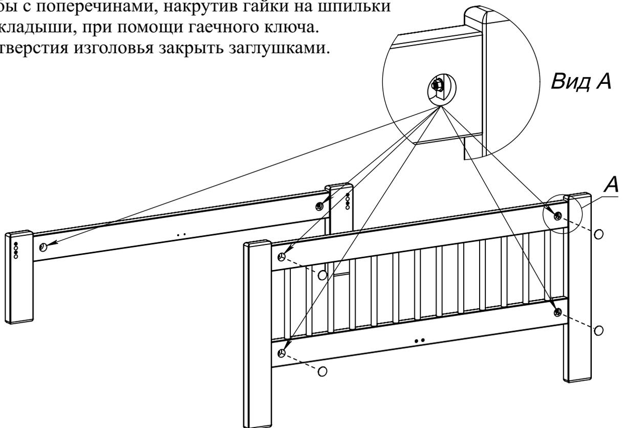
Аналогично вкрутить резьбовые шпильки и установить шкранты в столбы изголовья и изножья. Установить вкладыши в крепёжные отверстия на шпильки. Стянуть столбы с царгами, накрутив гайки на шпильки до упора во вкладыши, при помощи гаечного ключа. Установить средник по центру кровати и притянуть его большими саморезами, через крепёжные отверстия по середине изножья и изголовья. Крепёжные отверстия закрыть малыми заглушками. Прикрепить большими саморезами к среднику ножки-опоры.
