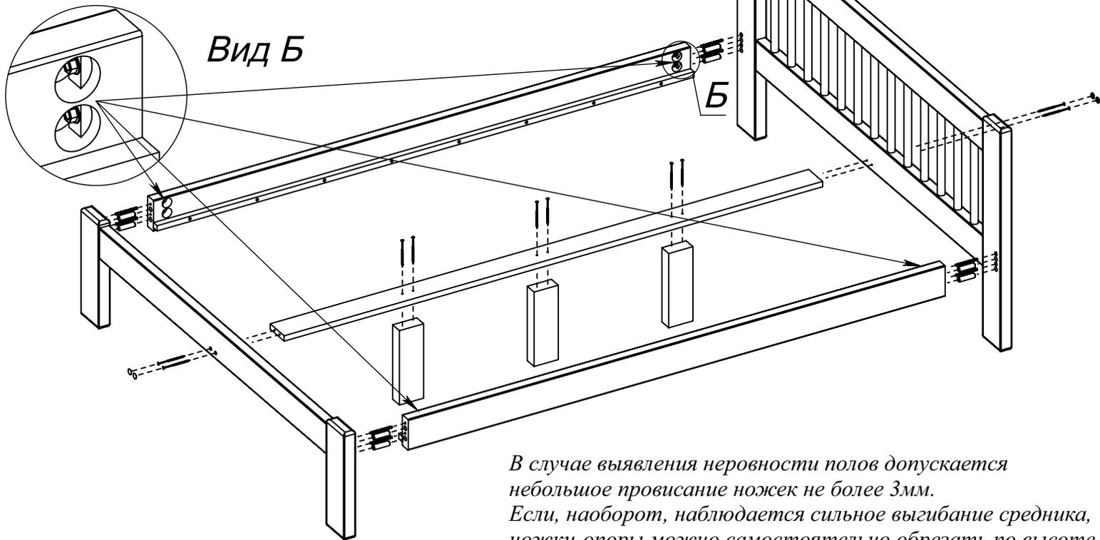
*В случае выявления неровности полов допускается небольшое провисание ножек не более 3мм. Если, наоборот, наблюдается сильное выгибание средника, ножки-опоры можно самостоятельно обрезать по высоте.*
