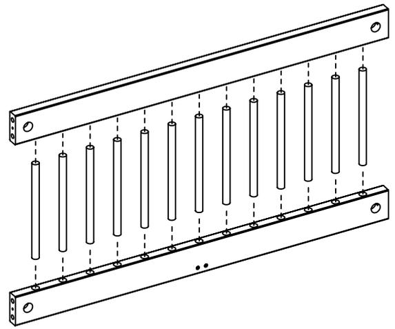
Вкрутить в столбы резьбовые шпильки и вставить шкранты. Соединить столбы с поперечинами.
